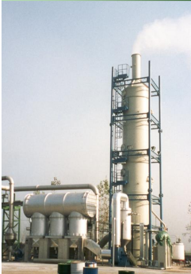
Un altro esempio di impianto per abbattimento SOV, dotato di combustore rigenerativo e colonna di assorbimento (Solchem -LO-)
