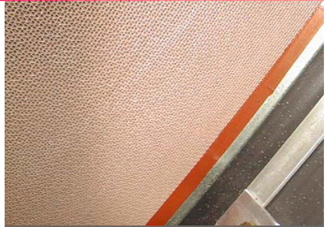
Figura 8 - Nel rotoconcentratore, le zeoliti si trovano incorporate in una struttura alveolare (honeycomb).
