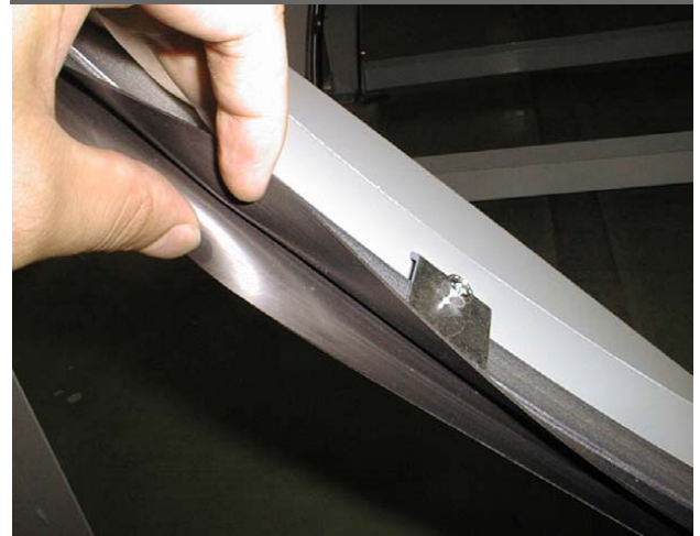
Figura 9 - Particolare del sistema che garantisce la tenuta a scorrimento con una guarnizione flessibile in contatto con il margine periferico del rotore.
