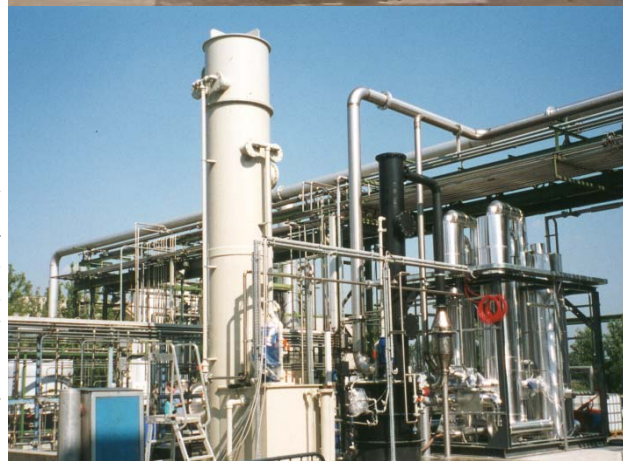
Impianto di criocondensazione, in esecuzione antideflagrante, preceduto da colonne ad assorbimento, una delle quali realizzata in polimero elettroconduttivo (SOLCHEM -LO-)
