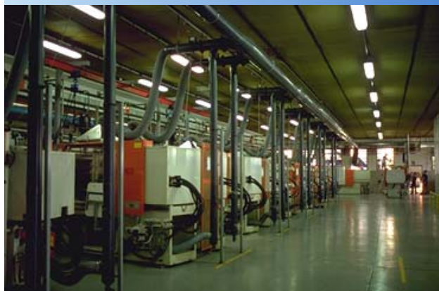
Linea aspirazione fumi a bordo presse (ARTEX)
